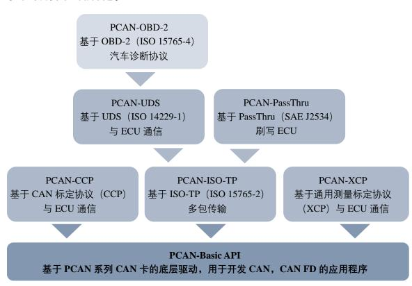
从上图可以看出,基于PCAN-USB产品,我们主要提供了基础的CAN通信开发包PCAN-Basic;用于ECU标定的CCP和XCP开发包;用于诊断方面的ISP-TP,UDS,OBD-2开发包。**以上API都是免费提供的**。
