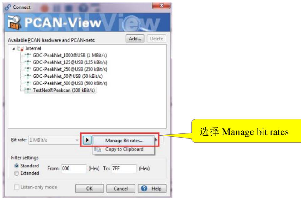
接着弹出波特率设定的窗口。选定使用的时钟频率后，点击“+”添加新的自定义波特率。在 Caption 填入名称,然后输入对应的 prescaler、tseg1、tseg2 和同步跳转宽度.这一部分就可以由用户参考使用不同的组合实现不同的波特率。
