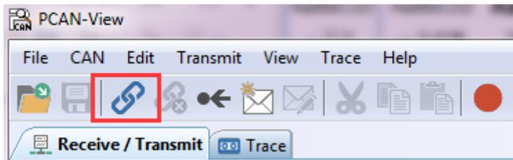
如果已经打开了 PCAN-View，想要更改波特率，可以点击菜单栏中的 CAN 或者点击工具栏中的连接按钮（链接状按钮），如图 2 中的红色方框所示，也会弹出图 3 中所示的连接对话框。
