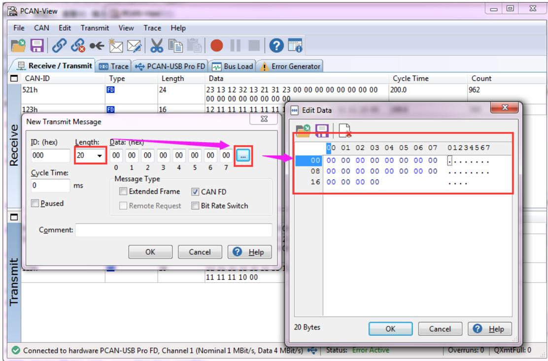
另外，在发送报文的界面上，点击软件左上角的保存按钮，可以将当前 Transmit 框中的 ID 保存为 xml 文件（发送列表），下次打开可以继续使用。
