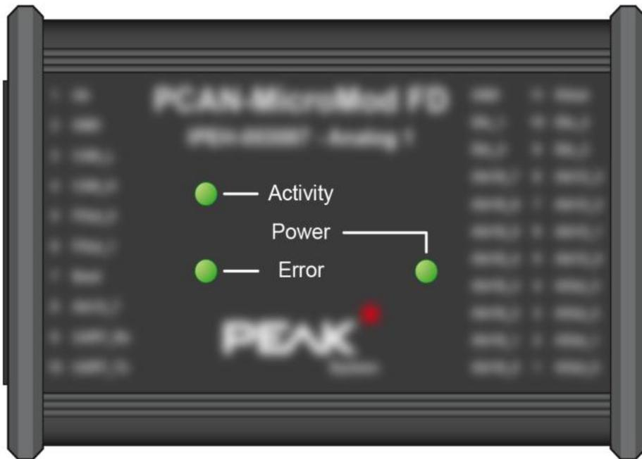
图 4 PCAN-MicroMod FD Analog 1 上的 LED 灯
